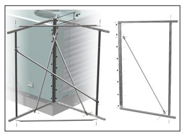
Build CORNER TRUSS and MID-SPAN TRUSS
